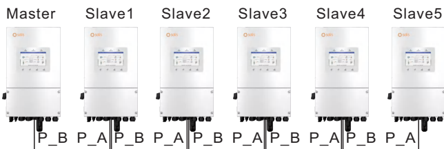
Figura 3.24 Conexão de terminal paralela
